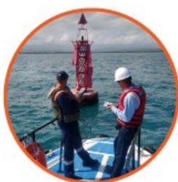
Controlar ayudas a la navegación (Marcas laterales, Marcas Cardinales, Marcas de peligro Aislado, Marcas de Agua Segura, Marcas Especiales, Marcas de Nuevos Peligros y Otras marcas, incluidas boyas de amarre y boyas meteorológicas para medición de parámetros oceanográficos y de meteorología marina) autorizadas a entidades públicas y privadas.
