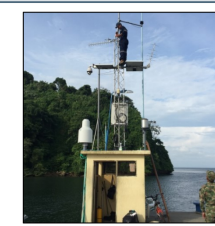
Figura 4. Mantenimiento del Mareógrafo de Tumaco y su respectiva CORS
