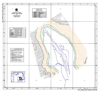
Cobertura levantamiento hidrográfico desembocadura Canal del Dique.
