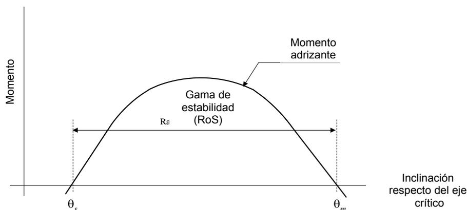
**Figura 3-2: Estabilidad residual de las unidades autoelevadoras**
